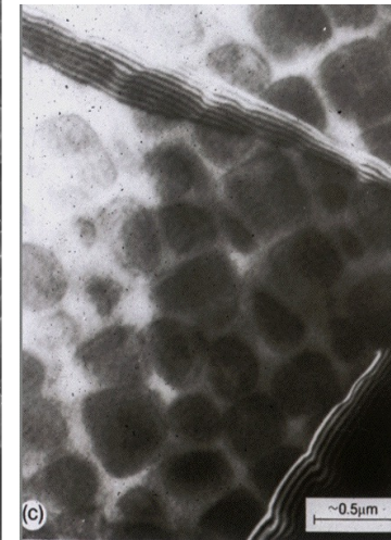
Précipités \text{Ni}_3\text{Al} (10-100 nm)
